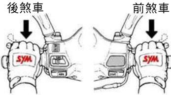
3. 按電動起動按鈕時，有按住後煞車或前煞車嗎？
