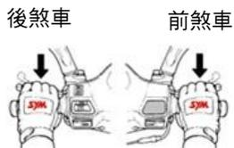
2. 汽油箱有汽油嗎？低油量警示燈是否亮起？      3. 按電動起動按鈕時，有按住後煞車或前煞車嗎？
