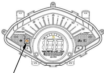
燃油噴射系統(EFI)故障警示燈
