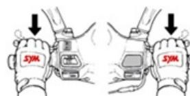
3. 按電動起動按鈕時，有按住後煞車或前煞車嗎？
