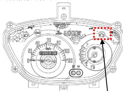
燃油噴射系統(EFI)故障警示燈
