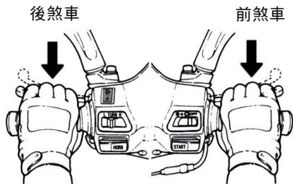
3. 按電動起動按鈕時，有按住後煞車或前煞車嗎？
